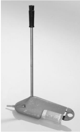
Foto 2: Sediman örnekleme işleminde kullanılan dh-48 kodlu sediman numune alıcı aleti
