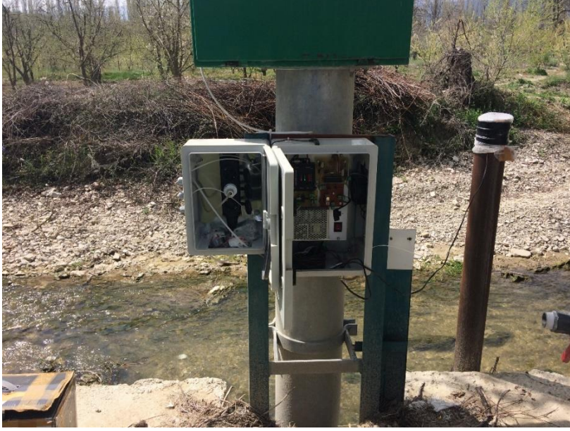
Foto 1: Korkuteli Çayı'nın Dereköy mevkiinde kurulan otomatik su seviyesi ölçüm istasyonu
