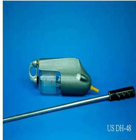
Foto 2: Sediman örnekleme işleminde kullanılan dh-48 kodlu sediman numune alıcı aleti
